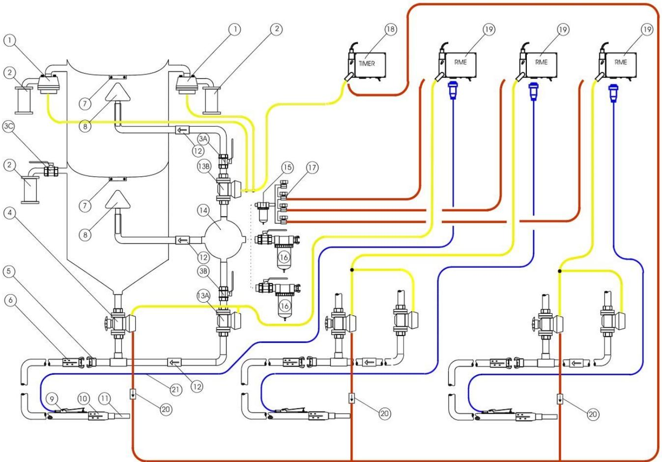
Doppelkammer Druckstrahlgerät für 3 Strahler mit elektro-pneumatischer Fernbedienung
